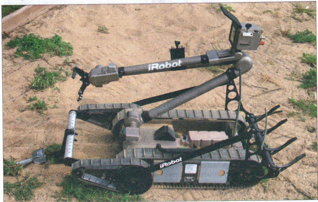
Вариант ДУМ «Пэкбот» 510 Engineer (справа захваты для подъема снарядов)
