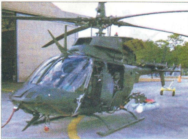
Размещение УР «Гриффин» на вертолете ОН-58Д «Кайова Уорриор»
