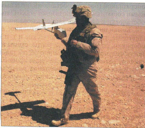
Разведывательные мини-БЛА RQ-11 «Равен» нашли широкое применение в ходе боевых действий в Ираке и Афганистане в интересах добытия детальной информации об обстановке для подразделений сухопутных войск и морской пехоты США
