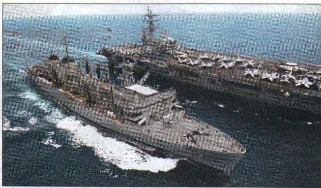
Передача грузов с универсального транспорта снабжения «Бридж» (Т-АОЕ-10) на АВМА «Рональд Рейган» (CVN-76)
